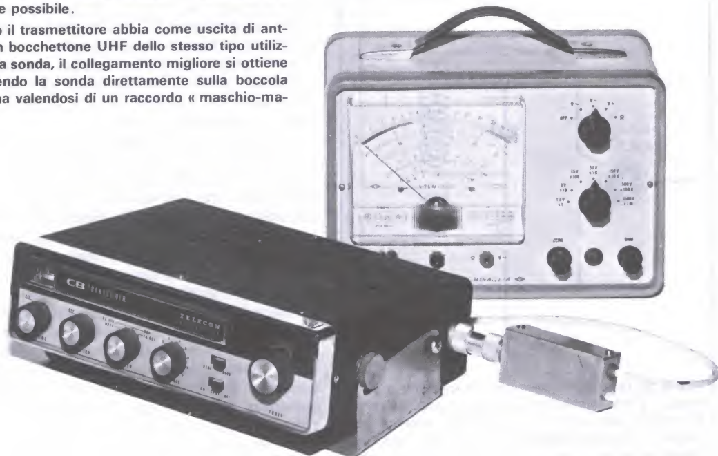
Fig. 6 Ecco come la sonda deve essere collegata all'uscita del TX. L'accoppiamento deve essere il più breve possibile.
